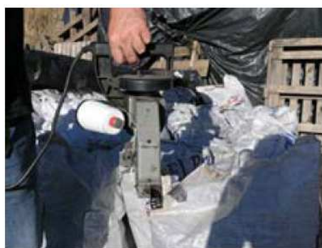
Máquina de coser para cierre de envases
